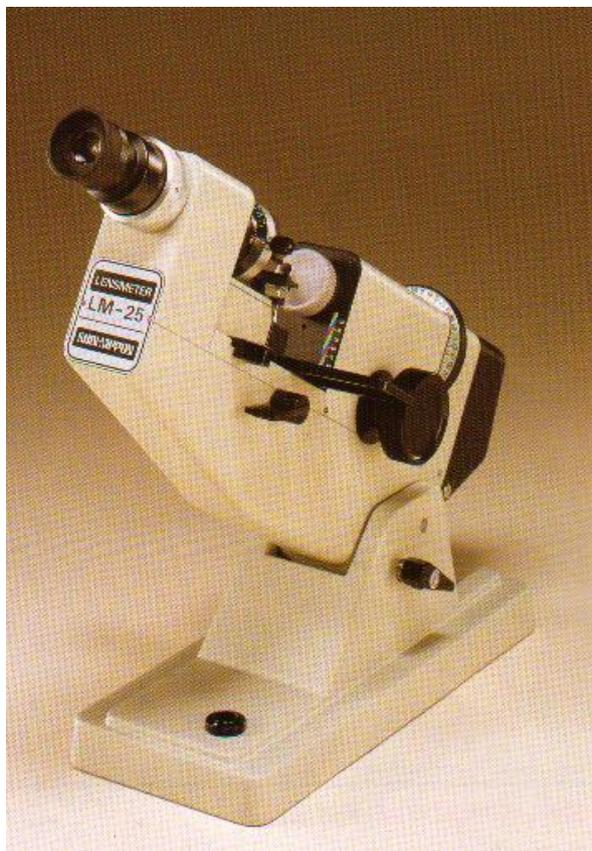
Диоптриметр окулярный предназначен для измерения задней вершинной рефракции и призматического действия стигматических и астигматических очковых линз, для нанесения положения оптического центра у стигматических очковых линз, направления главных сечений у астигматических очковых линз. Регулируемая по углу наклона консоль позволяет выбрать наиболее удобное положение, что значительно снижает утомляемость оператора.
