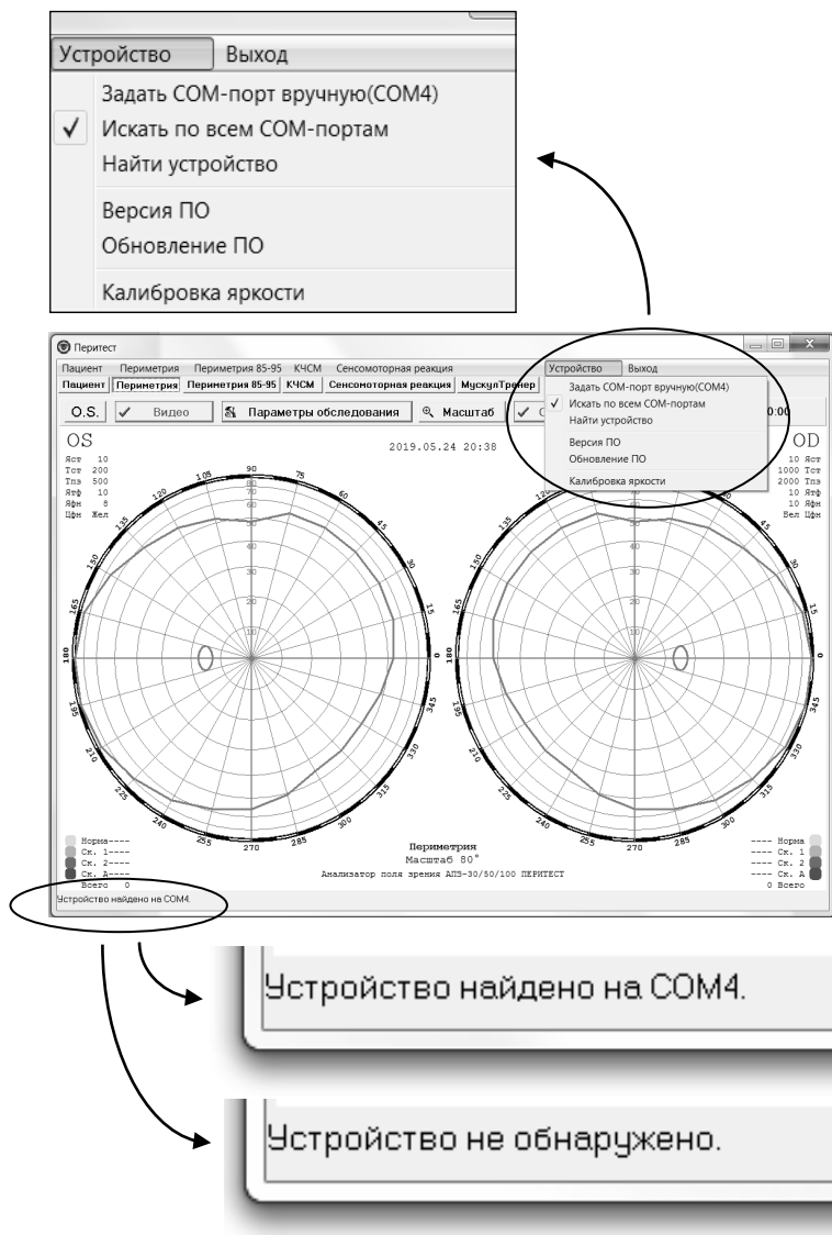
Подключение анализатора ПЕРИТЕСТ к компьютеру
