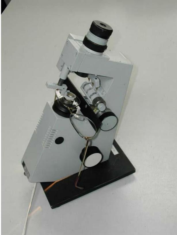
Диоптриметр оптический ДО-3 предназначен для измерения задней вершинной рефракции и призматического действия очковых линз диаметром от 34 до 75 мм, для нанесения положения главных сечений у астигматических очковых линз и направления линии „вершина — основание" у призматических очковых линз.
