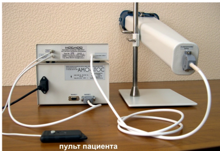
Рис.5. Подключение электронного блока приставки "КАСКАД" к аппарату "АМО-АТОС".
